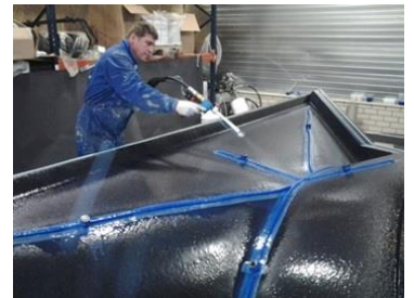
上：シートワックスでバキューム気道成形 下：特殊シリコンフィルム吹付作業 (樹脂ランナーを設置している)
