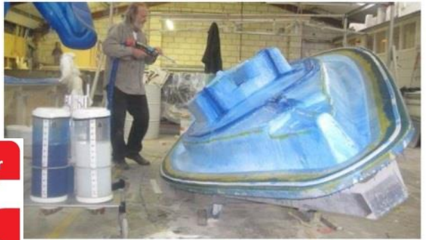
スプレー機による、特殊シリコンフィルム (B 型) 成形の様子
