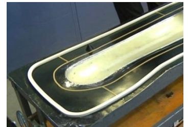
上：シートワックスでバキューム気道成形 下：特殊シリコンフィルム吹付作業 (樹脂ランナーを設置している)
